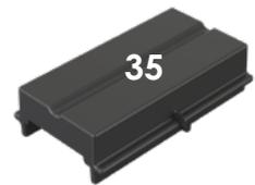
Längs-Verbinder für die Längsverbindungen zwischen zwei VersiFrame Profilen. Bitte immer einen Abstand von mind. 5mm zwischen zwei Längsprofilen beim Stecken einhalten, um Probleme aufgrund der Ausdehnung zu vermeiden.
