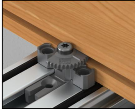
Dielen können entfernt und wieder montiert werden. Der Exzenter kann durch das Lösen der Schraube um ein Viertel gedreht werden, um die Diele zu entfernen.
